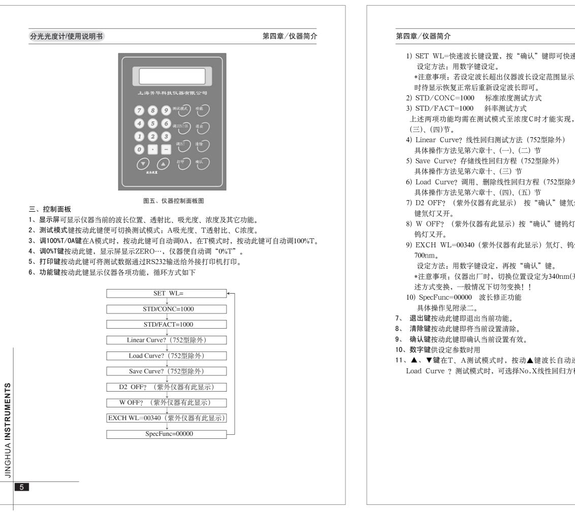
分光光度计/使用说明书 1) SET WL=快速波长键设置,按"确认"键即可快速进入WL=XXX.Xnm测试波长 \*注意事项:若设定波长超出仪器波长设定范围显示屏将显示:WaveLength err,此 上述两项功能均需在测试模式至浓度C时才能实现,具体操作方法见第六章九、 6) Load Curve?调用、删除线性回归方程(752型除外) 7) D2 OFF? (紫外仪器有此显示) 按"确认"键氘灯关显示D2 ON?, 再按"确认" 8) W OFF? (紫外仪器有此显示) 按"确认"键钨灯关显示W ON?, 再按"确认"键 9) EXCH WL=00340 (紫外仪器有此显示) 氘灯、钨灯切换位置设定,范围为300nm~ \*注意事项:仪器出厂时,切换位置设定为340nm(开机时默认),如作特殊测试可按上 11、▲、▼键在T、A测试模式时,按动▲键波长自动递增,按动▼键波长自动递减;在 Load Curve ? 测试模式时,可选择No.X线性回归方程。
